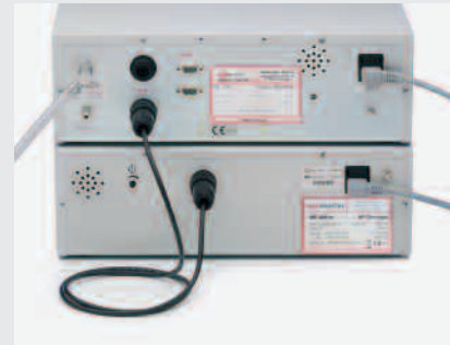
La connexion entre le ME MB 3 de KLS Martin et le diffuseur d'argon MB 181 de KLS Martin s'effectue avec le câble de signalisation 80-181-51-04.
