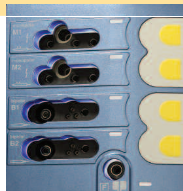
Version «e» maxium® avec module de connexion pour accessoires 5 mm
